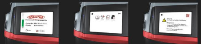
Über das interaktive Touchdisplay können Laufzeiten, Störungen, Wartungen, das Datum und die Uhrzeit ausgesetzt werden. Der Startbildschirm ist individuell einstellbar. So können z.B. Objekt- und Anwenderdaten dauerhaft eingespielt und angezeigt werden.
